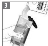
Naplňte zásobník na vodu 0.5 L vody a přidejte odvápnovací tekutinu Nespresso.
