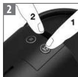
Stlačte a podržte tlačidlo Lungo a zapnite kávovar.
