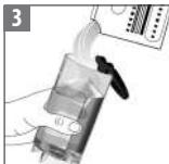
Nalejte do nádržky na vodu 0,5 l vody a odvápňovací roztok Nespresso.
