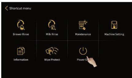
**3 žingsnis:** Sekite aparato ekrane rodomus žingsnius ir aktyvuokite „lengvojo išjungimo“ režimą (norėdami aparatą vėl įjungti, spauskite ir 3 sekundes palaikykite ant viršutinės plokštės esantį apvalų mygtuką).
