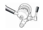
10. So lange hebeln, bis das Duschensieb mit der Dichtung richtig sitzt
