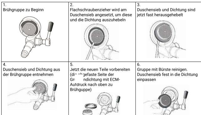
Mit der Hand das Duschensieb samt Dichtung einsetzen
