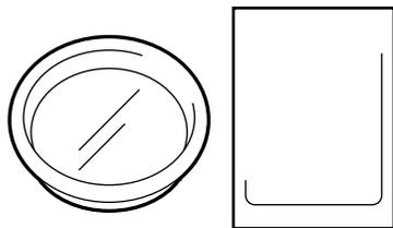
Во избежание образования накипи, которая откладывается внутри бойлера, мы рекомендуем всегда использовать фильтр-умягчитель воды на основе ионообменных смол Lelit, который, будучи вставленным в резервуар, очищает воду от солей кальция и магния, которые образуют накипь и влияют на вкус кофе. Порядок использования и замены указан на упаковке самого фильтра.
