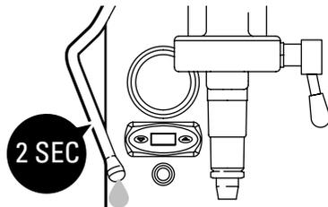
Tauchen Sie das Rohr so ein, dass das Ende des Dampfkolbens in der Nähe der Wand des Kännchens ist (stellen
