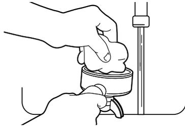
Detergi il portafiltro per rimuovere i residui grassi del caffè che influiscono negativamente sul gusto dell'espresso. Lava la parte esterna del tubo vapore con un panno umido e fai passare un po' di vapore nel tubo per eliminare tutti i residui interni di latte che potrebbero ostruire il passaggio del vapore rendendo più difficile montare la schiuma in maniera ottimale.
