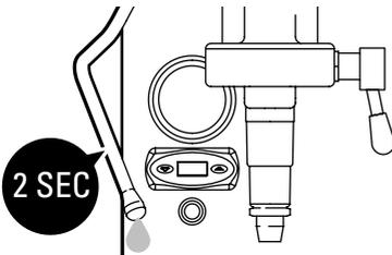
Scufundați tubul astfel încât capătul bulbului pentru abur să fie aproape de peretele câinii (imaginându-vă secțiunea superioară divizată în patru părți și poziționându-vă în centrul uneia dintre ele) și cu un centimetru sub suprafața laptelui. Deoarece laptele crește,
