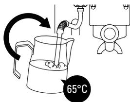
Hunde el tubo hasta el fondo e inclina el jarro para crear un vórtice. Caliente la leche hasta la temperatura deseada sin superar los 65 °C. *Cierre el vapor.* Trabaja la leche obtenida anteriormente golpeando ligeramente sobre una superficie el jarro para eliminar cualquier burbuja y a continuación, girándolo con movimientos amplios mezclar bien la leche y la espuma. Lo que se debería conseguir es una superficie suave, cremosa y sin burbujas.
