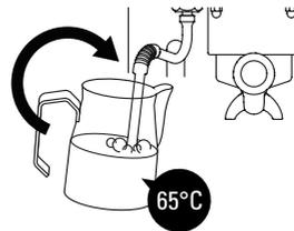
Scufundați tubul în lapte până la capăt și înclinați cana pentru a crea un vârtej. Încălziți laptele până la temperatura dorită fără a depăși 65°C. *Închideți aburul.* Prelucrați laptele obținut înainte, zăbătând ușor cana de masă, pentru a elimina eventualele bule de aer, rotind-o apoi cu mișcări ample pentru a amesteca bine laptele și spuma. Trebuie să obțineți o suprafață netedă, cremoasă și fără bule.
