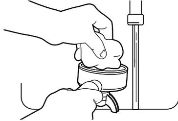
Ștergeți suportul de filtru pentru a îndepărta reziduurile grase de cafea, care influențează negativ gustul espressoului. Spălați partea externă a tubului de abur cu o cârpă umedă și lăsați să iasă puțin abur din tub, pentru a elimina toate reziduurile interne de lapte, care pot obstrucționa trecerea aburului, făcând dificilă crearea spumei într-o manieră optimă.
