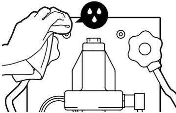
Verwenden Sie keine Scheuermittel und tauchen Sie die Maschine nicht ins Wasser. Für die sorgfältige Wartung empfehlen wir Ihnen die Bürste von Lelit (Code Reinigung-Kit PLA9101 – nicht enthalten), mit der Sie die Duschsiebe und Zwischenräume zwischen den Dichtungen perfekt reinigen können, indem Sie alle Flecken und Rückstände von Kaffeepulver auch aus den schmalsten Ritzen entfernen können.
