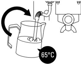
pas de décharger un peu de vapeur pour éviter que le lait pénètre dans les orifices de l'embout et de nettoyer la buse avec un chiffon humide.
