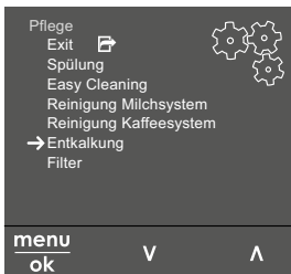
Abb. 7: Zum Programm Entkalken navigieren
