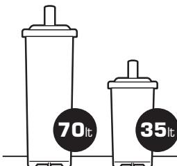
Per evitare il formarsi di questo calcare che si deposita anche nei circuiti interni, ti consigliamo di utilizzare e sostituire periodicamente il filtro addolcitore a resine Lelit che, inserito nel serbatoio, purifica l'acqua dai sali di calcio e magnesio che precipitando formano le incrostazioni di calcare e compromettono il gusto del tuo caffè.
