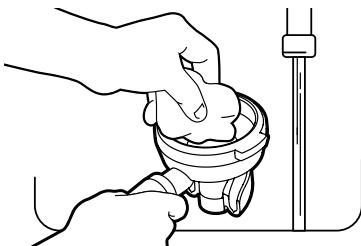
Detergi il portafiltro per rimuovere i residui grassi del caffè che influiscono negativamente sul gusto dell'espresso. Lava la parte esterna del tubo vapore/acqua calda con un panno umido e fai passare un po' di vapore nel tubo per eliminare tutti i residui interni di latte che potrebbero ostruire il passaggio del vapore rendendo più difficile montare la schiuma in maniera ottimale.
