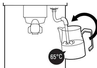
Scufundați tubul în lapte până la capăt și încinați cana pentru a crea un vârtej. Încălziți laptele până la temperatura dorită fără a depăși 65°C. Închideți aburul. Prelucrați laptele obținut înainte, zbătând ușor cana de masă, pentru a elimina eventualele bule de aer, rotind-o apoi cu mișcări ample pentru a amesteca bine laptel și spuma. Trebuie să obțineți o suprafață netedă, cremoasă și fără bule.
