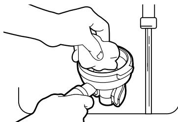
Ștergeți suportul de filtru pentru a îndepărta reziduurile grase de cafea, care influențează negativ gustul espressoului. Spălați partea exterioară a tubului de abur cu o cârpă umedă și lăsați să iasă puțin abur din tub, pentru a elimina toate reziduurile interne de lapte, care pot obstrucționa trecerea aburului, făcând dificilă crearea spumei într-o manieră optimă.
