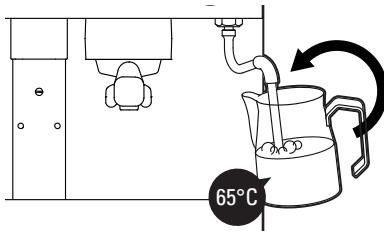
Affonda il tubo nel latte e inclina il bricco per creare un vortice. Scalda il latte fino alla temperatura desiderata senza superare i 65°C. *Chiudere il vapore.* Lavora il latte ottenuto sbattendo leggermente su un piano il bricco per eliminare eventuali bolle e successivamente ruotandolo con movimenti ampi per tenere ben amalgamati il latte e la schiuma. Quello che dovreste ottenere è una superficie liscia, cremosa e priva di bolle.
