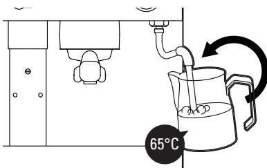
Hunde el tubo hasta el fondo e inclina el jarro para crear un vórtice. Caliente la leche hasta la temperatura deseada sin superar los 65 °C. *Cierre el vapor.* Trabaja la leche obtenida anteriormente golpeando ligeramente sobre una superficie el jarro para eliminar cualquier burbuja y a continuación, girándolo con movimientos amplios mezclar bien la leche y la espuma. Lo que se debería conseguir es una superficie suave, cremosa y sin burbujas.
