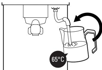
Enfoncez la buse au fond et inclinez le pichet pour créer un tourbillon. Réchauffez le lait jusqu'à obtenir la température désirée sans dépasser 65°C. *Fermez la vapeur.* Avec le lait obtenu, tapez d'abord légèrement le pichet sur un plan pour éliminer toutes les bulles éventuelles, faites-le tourner avec des mouvements amples pour que le lait et la mousse restent bien amalgamés. Vous devriez obtenir une surface lisse, crémeuse et sans bulles.
