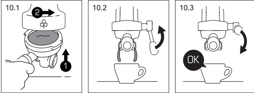
Insérez le filtre que vous voulez utiliser dans le porte-filtre (G) et remplissez le filtre avec la quantité de café moulu appropriée au type de filtre chois. Utilisez le tamper (D) pour presser le café dans le filtre. Fixez le porte-filtre (G) au groupe distributeur (13) et assurez-vous que la poignée est alignée avec le symbole du cadenas présent sur le groupe distributeur (Fig. 10.1).
