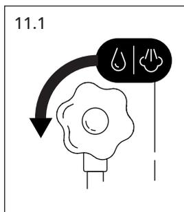
Faites pivoter les boutons (3 ou 12) dans le sens inverse des aiguilles d'une montre pour distribuer de la vapeur et de l'eau chaude (Fig. 11.1).
