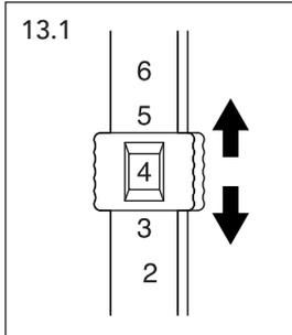
Pour prévenir la formation de calcaire et assurer un meilleur résultat dans la préparation des boissons, utilisez le filtre adoucisseur (H). Le filtre fourni a une autonomie testée au niveau chimique pour 35 litres d'eau.
