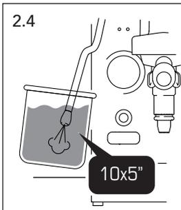
**Nettoyage du tube vapeur.** Remplissez un récipient de 500 ml avec de l'eau froide et, après avoir ajouté le contenu d'une fiole de détergent liquide (F ou PLA9203), trempez la lance à vapeur (7) dans la solution.
