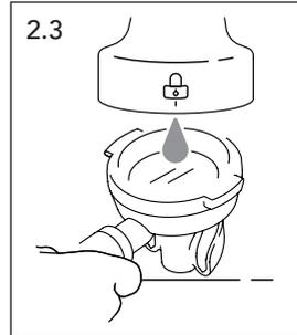
**Backflushing.** Insérez le filtre aveugle (C) dans le porte-filtre (G) et versez le contenu d'un sachet de détergent en poudre (F ou PLA9201). Fixez le porte-filtre (G) au groupe distributeur (13) et soulevez le levier (14) pour activer la distribution pendant 10 secondes. Arrêtez la fonction et attendez 10 secondes. Répétez 10 fois (Fig. 2.2).
