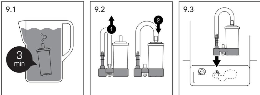
Avant d'installer le filtre adoucisseur (H) à l'intérieur du réservoir (10), trempez le filtre dans une cruche avec de l'eau pendant environ 3 minutes pour éviter que l'air à l'intérieur puisse causer un mauvais fonctionnement de la machine (Fig. 9.1).
