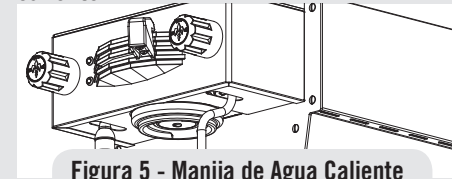
Figura 5 - Manija de Agua Caliente
