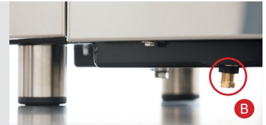
9. Sollte eine Justierung des Pumpendruckes erforderlich sein, so kann diese vom Fachmann über die Einstellschraube unter der Maschine (siehe Abb. B) durchgeführt werden. Bitte für den Verschlussring einen 14 mm Schraubenschlüssel und für die Schraube selbst einen 10 mm Schraubenschlüssel verwenden.
