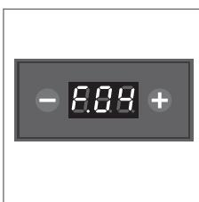
Per svuotare la caldaia vapore, posizionare un contenitore sotto la lancia acqua, scegliere **F.04** nei menu e confermare
