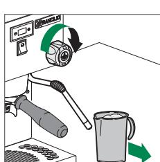
Terminata l'erogazione desiderata, chiudere il rubinetto e rimuovere il bricco. Pulire la lancia con un panno umido
