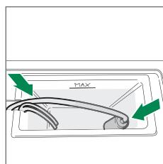
Controllare che i tubi siano inseriti nel serbatoio e che la trappola del vuoto sia incastellata nell'apposito spazio al suo interno
