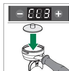
Quando il display mostra CL3, rimuovere il portafiltro e inserire nuovamente la membrana filtro cieco
