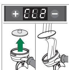
Quando il display mostra CL2, rimuovere il portafiltro con membrana filtro cieco e risciacquare entrambi con acqua
