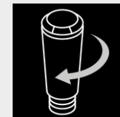
Filter in Wassertank eindrehen
